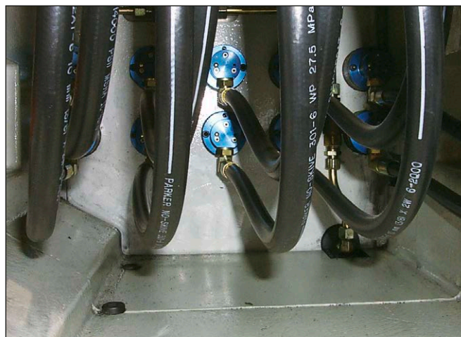
Bezložiskové přívody Deublin 1117 na automobilovém přenosovém potrubí.
