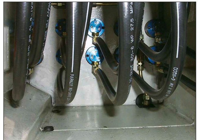
Deublin 1117 lagerlose Drehdurchführung an Transferstraße
