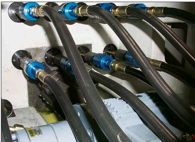
Deublin 1116 Drehdurchführung mit eigener Lagerung an Transferstraße
