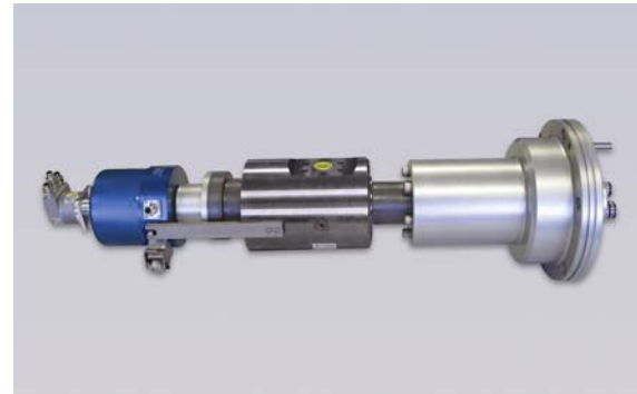
Drehdurchführung für Offshore-Windkraftanlagen mit Schleifring und Drehgeber – DEUBLIN bietet eine komplette Lösung an, die den Anforderungen in den Bereichen Hydraulik, elektrische Leistung, EtherCAT und Positionsbestimmung entspricht.
