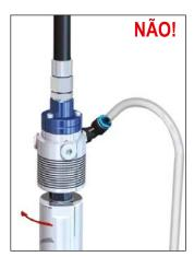
ERRADO: a linha de drenagem aponta para cima, podendo inundar os rolamentos da junta.
