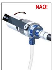
ERRADO: a carcaça da junta está rigidamente presa ao fuso. Sem um alinhamento 100% perfeito, isso cria uma carga lateral que leva à falha precoce do rolamento.
