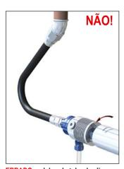
ERRADO: a dobra do tubo de alimentação está muito apertada. Quando pressurizado, o tubo de alimentação pode criar uma grande carga lateral nos rolamentos da junta.
