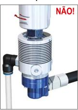
ERRADO: a junta aponta para cima. Os contaminantes do fluido refrigerante se acumularão na parte inferior e irão afetar a selo adequada.
