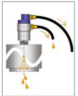
Quando a linha de alimentação desce da junta rotativa, qualquer fluido refrigerante entre a junta e a válvula de controle permanecerá no tubo durante a troca da ferramenta. Isso reduz a quantidade de drenagem tanto da ponta do fuso quanto da linha de drenagem da junta.
