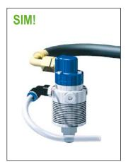
CERTO: o encaixe em cotovelo é usado para evitar uma curvatura apertada no tubo de alimentação. O tubo de drenagem se inclina para baixo.
