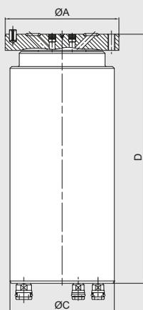
**Conexão radial montada no rotor**
