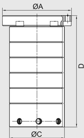
**Conexão axial montada no rotor
