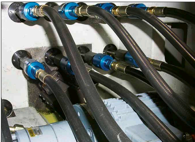
Deublin 1116 Drehdurchführung mit eigener Lagerung an Transferstraße
