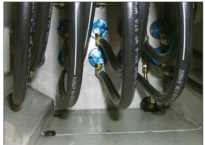
Deublin 1117 lagerlose Drehdurchführung an Transferstraße
