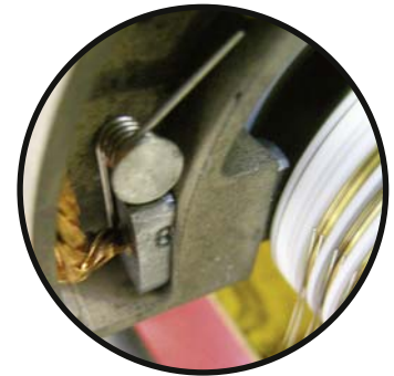
Maßgefertigte DEUBLIN-Halterung für Leistungsübertragung durch Graphitbürsten
